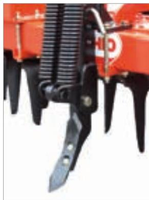
Spurlockerer mit Spiralfedersicherung (Beipack, 2 Stück)
