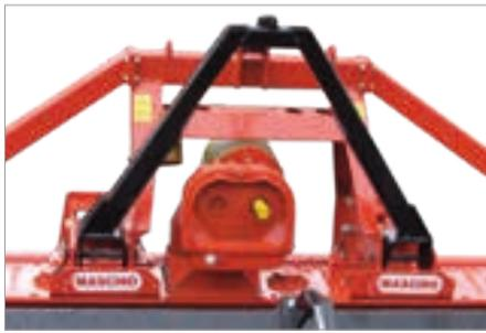
Aufsatteldreieck für pneumatische Drillmaschine (Fremdfabrikat)
