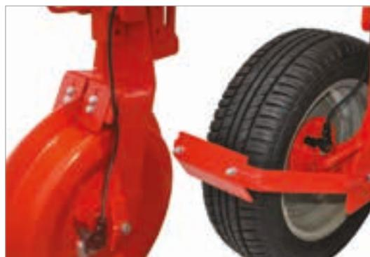
Stahl- oder Gummiräder mit Geschwindigkeitssensor
