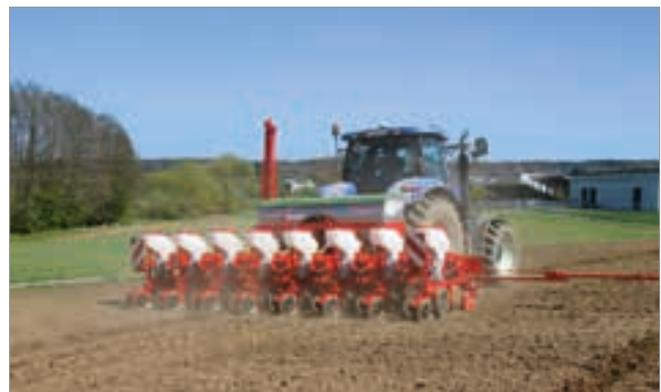
Pneumatische Einzelkornmaschine mit Teleskoprahmen. Transportbreite 3,0 m.
