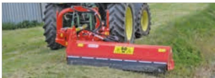
GIRAFFA SE mit außenliegendem Getriebe
