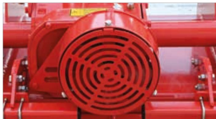
Ölbad-Wechselradgetriebe mit Luftkühlung
