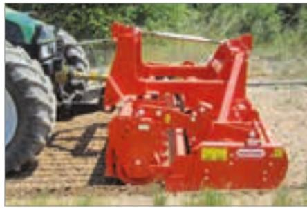
Frontanbaubock inkl. Walterscheid-Gelenkwelle für Front, Mindesthöhe Zapfwellenstummel am Schlepper = 770 mm
