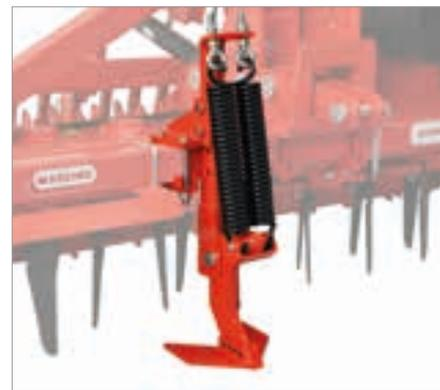
Spurlockerer mit Spiralfedersicherung und Delta-Schar (Beipack, 2 Stück)
